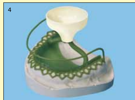
4 В процессе литья сжатый воздух вытесняется в воздухопроводные каналы, способствуя получению отливок без усадочных раковин, которые легко припасовывать.
