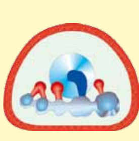
Мостовидный протез любой формы ввиду формы муфеля располагают вне центра нагрева.
