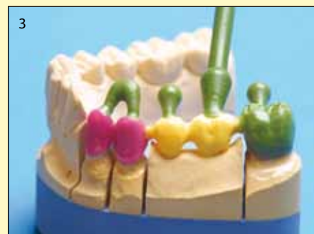
3 Двойные каплевидные резервуары используют на двух одинаковых по объёму объектах. Это облегчает размещение и сокращает трудоёмкость.
